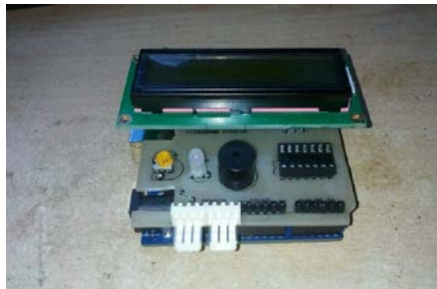
Gambar 9 Rangkaian output terdiri dari LCD,LED,Buzzer.
