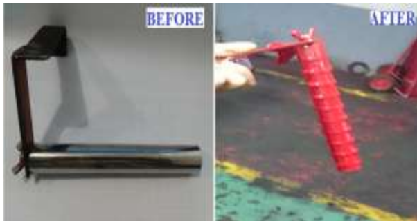
Gambar 10. Pemasangan Magnet Trap
