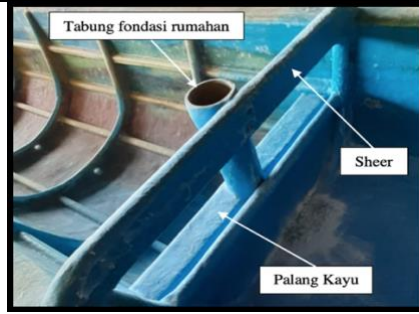
Gambar 108. Fondasi Rumahan Pada Bagian Dalam Perahu Fiber Direkatkan Pada Sheer dan Diikatkan Pada Palang Kayu (Tulangan) (Foto Rochyat 2022).
