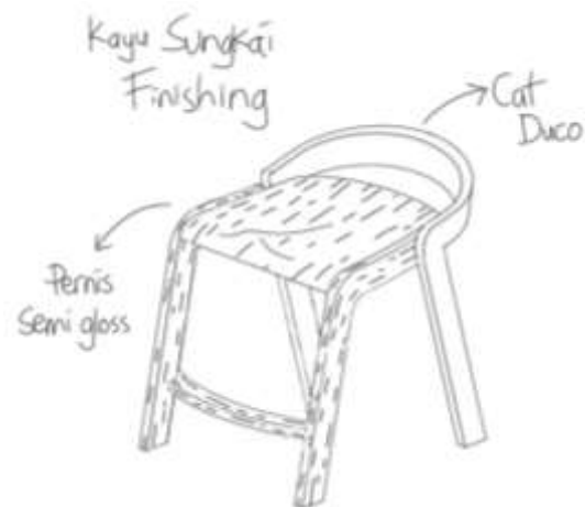
Gambar 15. Sketsa hasil analisis finishing kayu sungkai pada perancangan Stool
