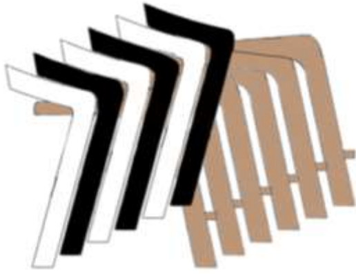
Gambar 6. Konsep sistem tumpuk pada rancangan Stool
