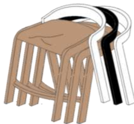
Gambar 13. Sketsa hasil analisis sistem tumpuk pada rancangan Stool
