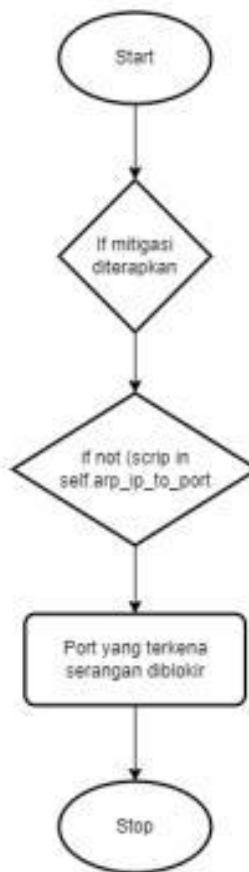
Gambar 5. Flowchart Sistem Mitigasi DDoS
