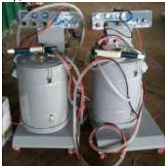
**Gambar 5.** Alat untuk proses *Powder Coating*
