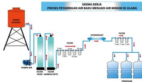
Gambar 7. Skema Kerja Rancangan Depot Air Minum (DAM)
