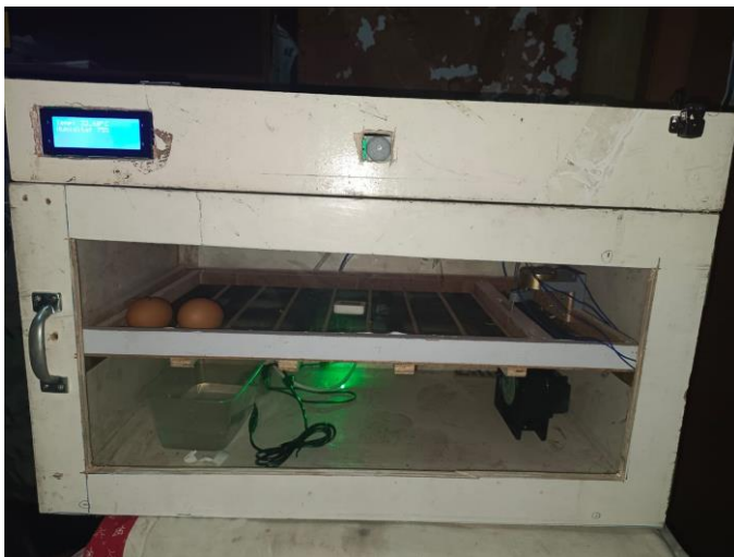
Gambar 5. Bagian Luar Inkubator Setelah Semua Perangkat Terinstal Di Ruang Inkubator
