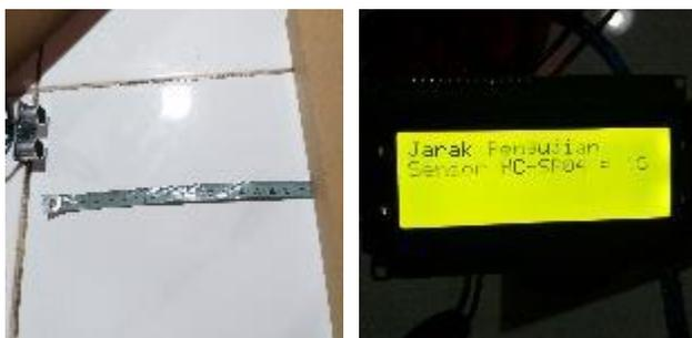
Gambar 14. Pengujian Sensor HC-SR04
