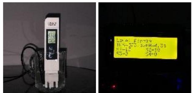
Gambar 15. Pengujian Sensor TDS
