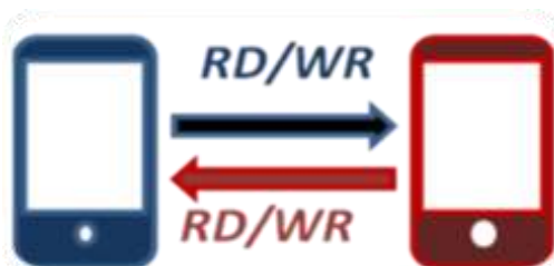
Gambar 6. Konsep kerja NFC antar perangkat.
