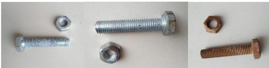
**Gambar 1:** Hasil proses perendaman material uji terhadap larutan asam  $H_2SO_4$ , Basa NaOH dan air laut selama 3x24 jam atau 3 hari
