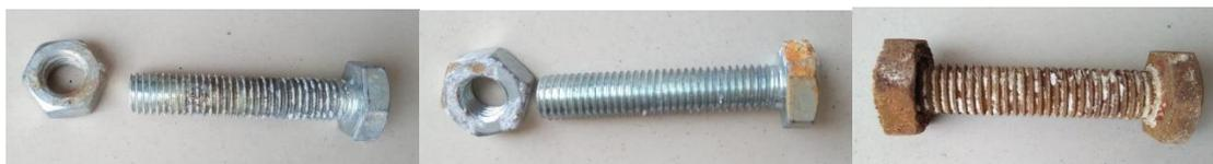
**Gambar 2:** Hasil proses perendaman material uji terhadap larutan asam  $H_2SO_4$ , Basa NaOH dan air laut selama 6x24 jam atau 6 hari
