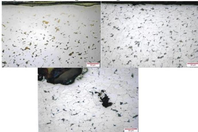
**Gambar 3:** Hasil uji mikro setelah dilakukan perendaman selama 3x24 jam atau 3 hari
