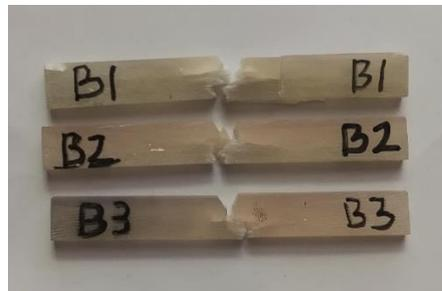
Gambar 5. Spesimen dengan kandungan Serat Kaca 13% Sesudah Uji Impact
