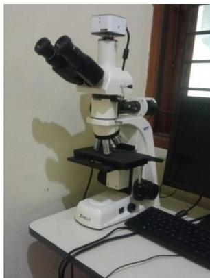
Gambar 3. Alat Uji Struktur Mikro
