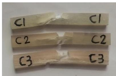
Gambar 6. Spesimen dengan kandungan Serat Kaca 16% Sesudah Uji Impact
