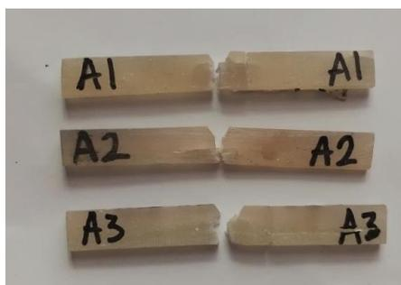
Gambar 4. Spesimen dengan kandungan Serat Kaca 10% Sesudah Uji Impact
