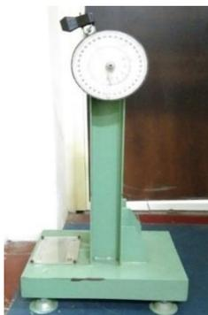
Gambar 2. Alat uji Impak Metode Charpy
