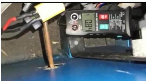
Gambar 3. Pengecekan arus dengan *clamp meter*
