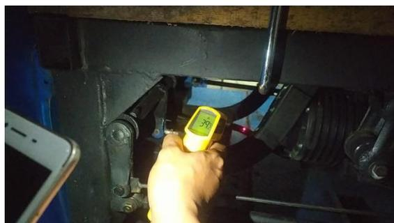
Gambar 4. Pengecekan temperatur dengan *thermo scanner*
