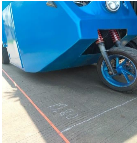
Gambar 1: Pengujian jarak pengereman pada kecepatan 40 Km/jam
