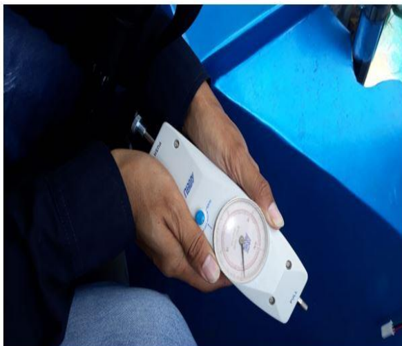
Gambar 3: Pengujian gaya tekan pedal rem pada kecepatan 40 Km/jam
