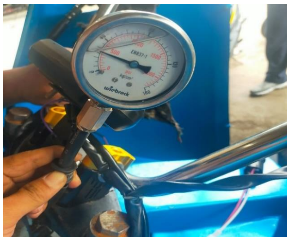
Gambar 4: Pengujian tekanan fluida rem depan pada kecepatan 40 Km/jam
