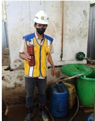
**Gambar 2.6:** Pengambilan sample pada tangka penyimpanan stok bahan bakar
