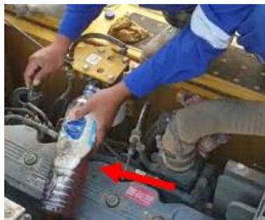
**Gambar 2.7:** Pengambilan sample pada out put main filter
