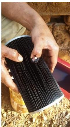
**Gambar 2.1:** Kondisi kerak pada kisi – kisi filter
