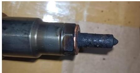
**Gambar 2.4:** Kerak pada ujunginjector
