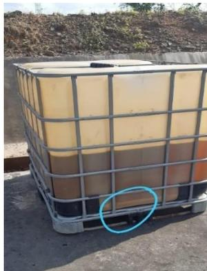
**Gambar 2.5:** Residu/endapan pada tangka penyimpanan
