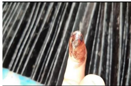
**Gambar 2.3:** Kerak pada hose/pipa sistem bahan bakar
