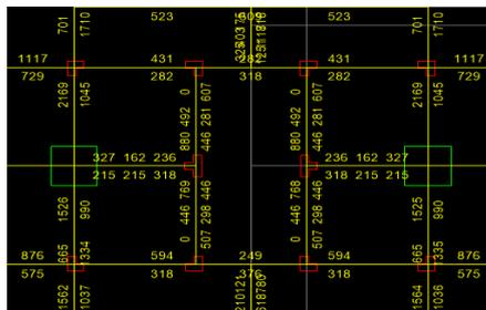
**Gambar 13** Hasil analisis struktur/check design structures ETABS untuk kolom L dan T
