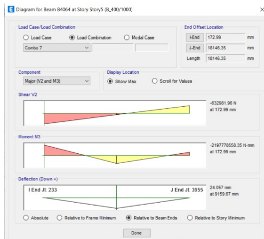
Gambar 13. Hasil analisis: momen lentur, gaya geser, lendutan glulam akibat kombinasi beban terfaktor paling maksimum.
