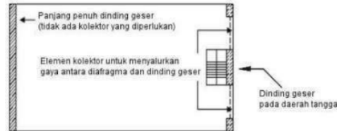
Gambar 5. Elemen Kolektor Pada Diafragma
