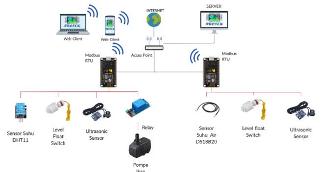
Gambar 7. Topologi Jaringan Sistem Komunikasi SCADA
