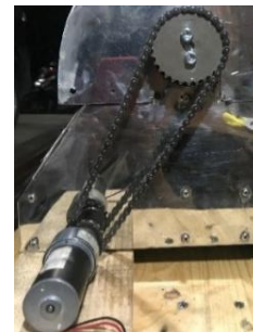
Gambar 9. Posisi gear dan rantai pada mesin sangrai
