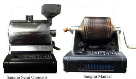
Gambar 12. Perbedaan desain mekanik mesin sangrai
