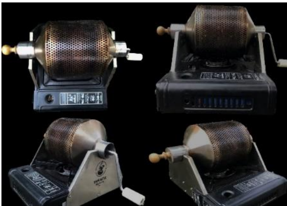
Gambar 5. Mesin sangrai manual 1kg
