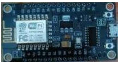
Gambar 2. NodeMCU ESP8266
