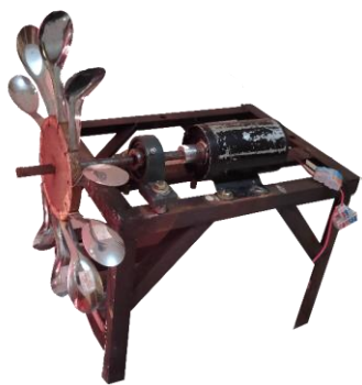
Gambar 6. Turbin serta Generator yang telah dihubungkan dengan fondasi
