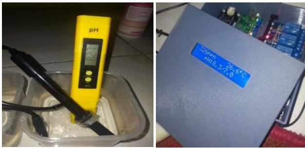
Gambar 12. Pengukuran sensor pH dan pH meter, Gambar 13. Tampilan nilai pH pada LCD
