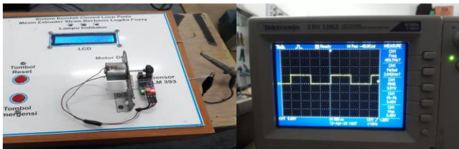
Gambar 5. Uji Thermocouple Temperature Sensor MAX6675 dengan Osiloskop[7]
