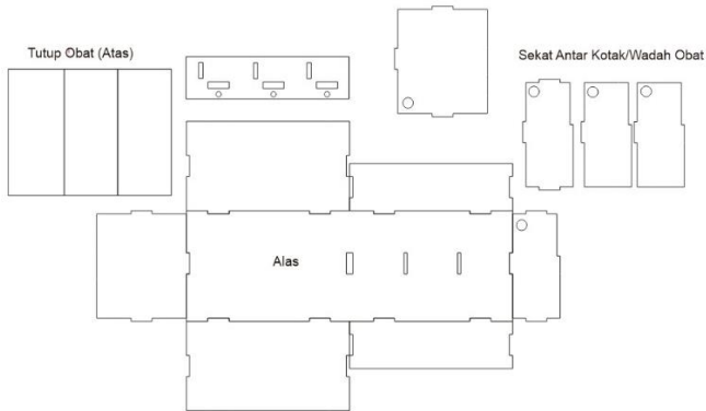
Gambar 4 Rancangan 2D Kotak Obat
