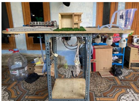
Gambar 8. Prototype Sistem Kontrol Gedung Perkantoran
