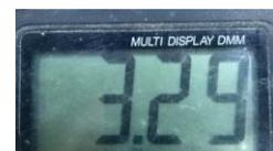
Gambar 5. Tegangan Supply untuk NRF24L01 pada Arduino pin 17 (3v3) pada Sisi Pemancar
