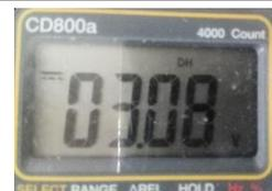
Gambar 7. Pengujian Supply NRF24L01 pada Arduino pin 17 (3v3) Sisi Penerima
