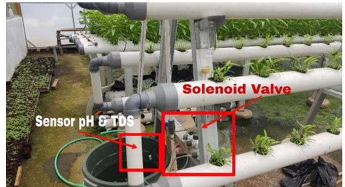
Gambar 7. Sistem Hidroponik yang Dibangun
