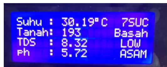
Gambar 10. Pengujian Sensor Suhu dengan Output Tampilan LCD
