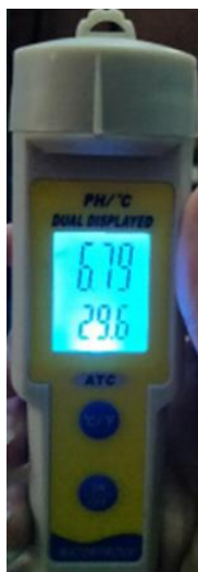
Gambar 16. Pengujian Sensor pH dengan Output Tampilan LCD
