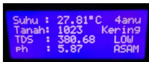
Gambar 14. Pengujian Sensor TDS dengan Output Tampilan LCD
