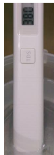
Gambar 15. Pengujian TDS dengan TDS Meter
