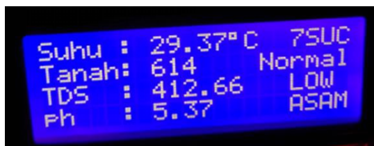
Gambar 12. Pengujian Sensor Soil Moisture dengan Output Tampilan LCD
