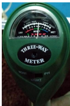
Gambar 13. Pengujian Kelembaban dengan Soil Meter
