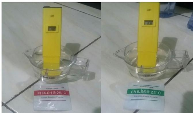
Gambar 3. Kalibrasi Ph Meter PH-009(I)
