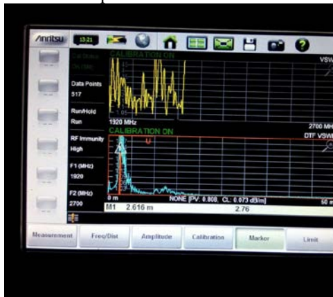
Gambar 12 Pengukuran nilai VSWR
