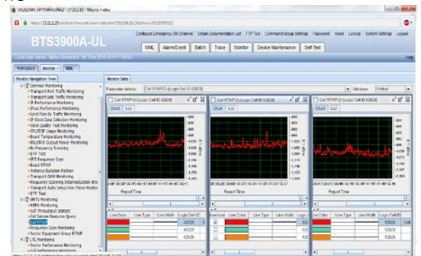
Gambar 18 Pengambilan nilai RTWP berdasarkan Cell RTWP
