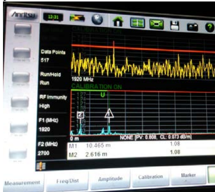
Gambar 16 Pengukuran Nilai VSWR setelah Troubleshooting
