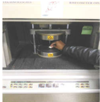
Gambar 3.2 Pengujian kompon menggunakan mesin Rheometer ODR2000
