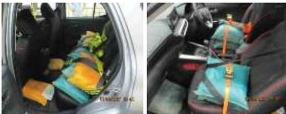
**Gambar 8.** Pemasangan beban pada unit mobil
