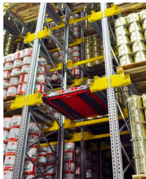
Gambar 2. Posisi Pallet Shuttle ketika berada pada salah satu lorong rak penyimpanan. [2]
