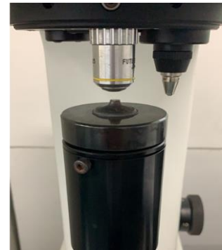
L1. 9 Proses Pengujian Kekerasan Dengan Vickers Hardness Tester
