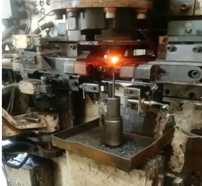
L1. 8 Proses Upsetter Forging Dengan Suhu 1230 Dengan Heating Time 14 detik
