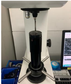
L1. 9 Proses Pengujian Kekerasan Dengan Vickers Hardness Tester
