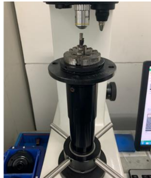
L1. 9 Proses Pengujian Kekerasan Dengan Vickers Hardness Tester
