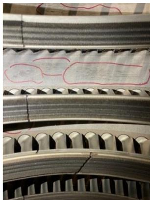
Gambar 3.1 Flowpath Scratch pada HPC Front Stator Case
