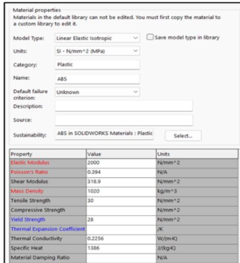
**Gambar 7.** Material properties ABS pada *solidworks* 2021
