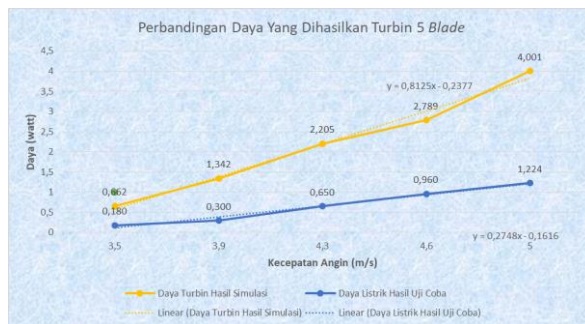
Gambar 14. Grafik perbandingan daya yang dihasilkan turbin variasi 5 blade antara uji coba dan simulasi.
