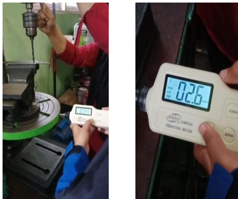
Gambar 2. Proses Percobaan Pengukuran di Meja Bor dan Dudukan Mesin Bor
