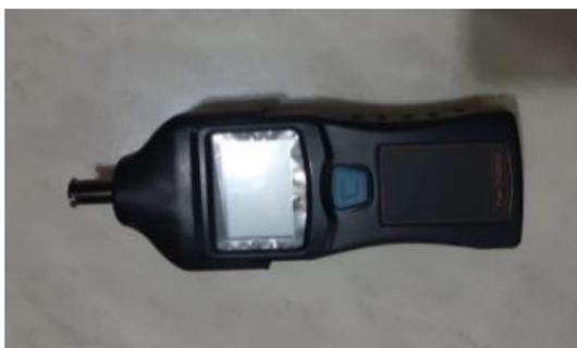
Gambar 8. Tachometer TM-7000
