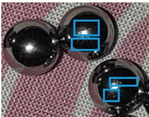
**Gambar 17.** Cacat sangkar pada *bearing* rusak.
