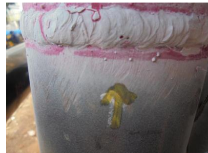
Gambar 3. Hasil Pengujian NDT Penetrant Test Hari ke-1
