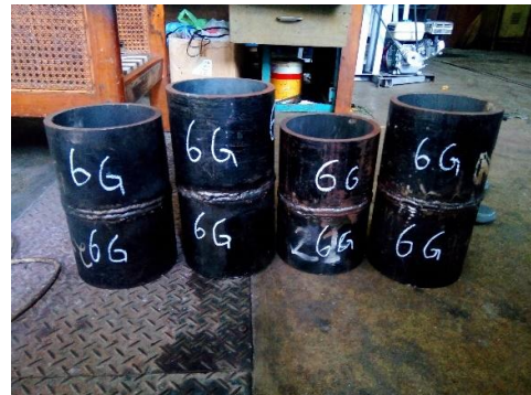
(b) Spesimen untuk posisi pengelasan HLO45 (6G)
