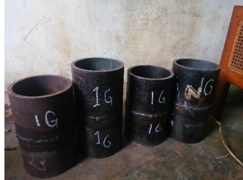
(a) Spesimen untuk posisi pengelasan PA (1G)
