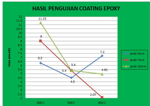
Gambar 9. Grafik hasil pengelupasan coating epoxy
