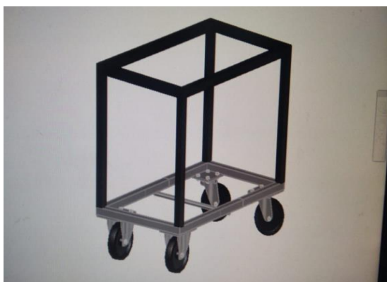
Gambar 7. Tempat Material Diharapkan dengan usulan tersebut material tidak ditempatkan di lantai sehingga tidak lembab.
