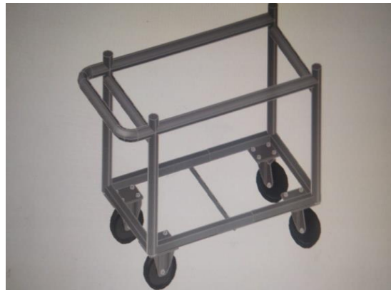
Gambar 8. Hanger Part WIP Diharapkan dengan pembuatan hanger , penaruhan part tidak bertumpuk yang bisa menyebabkan part menjadi cacat defom .
