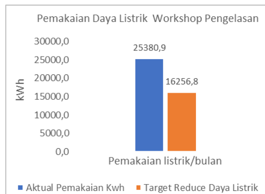
Gambar 5. Target penurunan pemakaian daya dengan penggunaan simulator las Sumber : Pengolahan data
