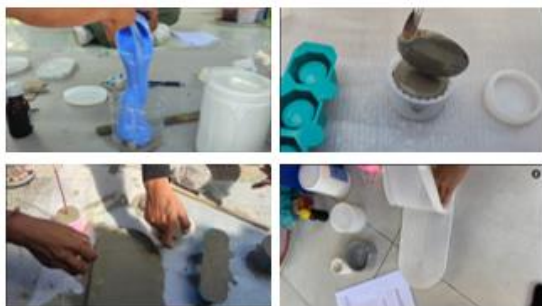
Gambar 4. Proses Produksi dengan silicone mold
