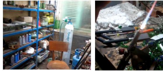
Gambar 1: Tabung gas (kiri), Alat las yang menyambung dengan tabung gas (kanan)
