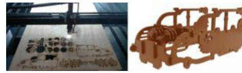
Gambar 9. Model 3 Dimensi sebagai tahap perencanaan dan proses produksi menggunakan cutting laser pada matrial multipleks (sumber: Riqki Van Gama, 2018)
