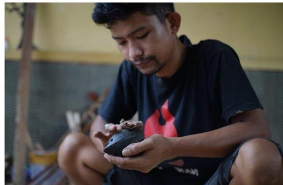
Gambar 9. Menghaluskan Papan Batok dengan Ampelas
