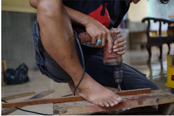
Gambar 6. Membuat Lubang untuk Uliran
